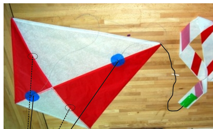
Mocowanie uzdy latawca, linią przerywaną zaznaczone są dodatkowe linki stosowane podczas lotów przy silnym wietrze
